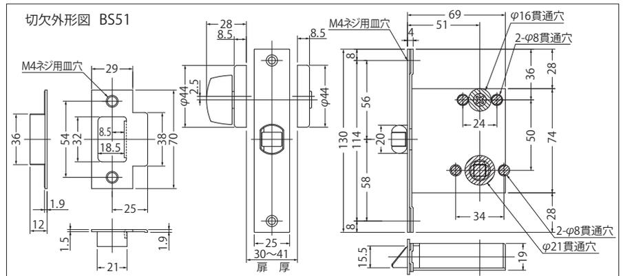
バックセット 51mm (8mm角芯) 取付扉厚 30mm~41mm
