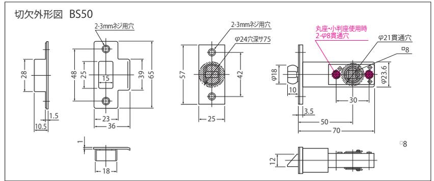
バックセット 51mm (8mm角芯) 取付扉厚 標準 30mm~45mm
