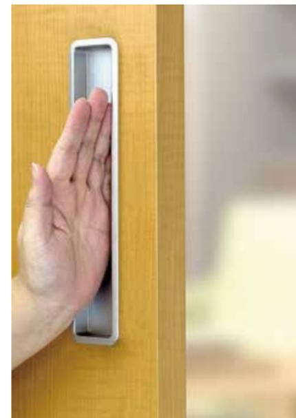
安価なユニバーサルデザインの樹脂引手(写真はバリアフリーの230mm)。裏角R6mmでルーター加工の引手穴に設置が簡単。
