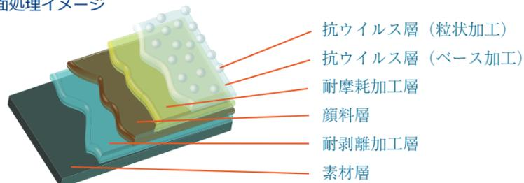
**耐摩耗加工** 耐久性向上のための耐摩耗加工
