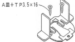
④ アダプターを外し、ネジで固定する
