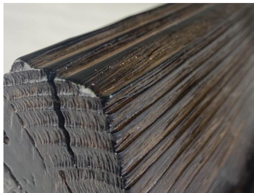
真空含浸技術での木質内部へのカラー染色例
