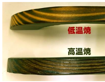
燃焼温度による色と凹凸の違い
