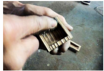
手作りによる凹形状の浮造(うづくり)
