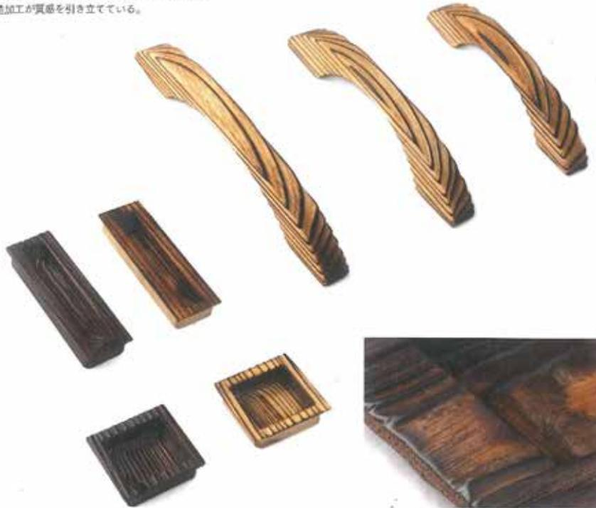
西日本を中心に使われてきた木材表面加工の伝統技法、焼杉。表面の炭化層が板の劣化を遅らせるため耐久性が高く、主に外壁に用いられている。この技法を引き手や取手などのインテリア部材に応用したいと開発したのが、ビドーが展開するプロジェクトwatomos(ワトモス)の「焼杉」シリーズだ。伝統工法を試行錯誤した結果、小さな部品でも伝統技法と同じような炭化層の形成に成功、製造特許も取得した。触っても手に「炭」が付着しない工夫も。さらに木の柔らかい部分を落として木目を浮き上がらせる浮造(うづくり)を施しており、質感もよい。色は濃淡の際立つブレンカラーの生地と、内部まで染料を含ませた落ち着いた風合いの茶染。6シリーズ全24種が揃う。
