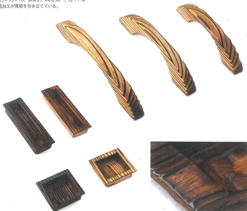
西日本を中心に使われてきた木材表面加工の伝統技法、焼杉。表面の炭化層が板の劣化を遅らせるため耐久性が高く、主に外壁に用いられている。この技法を引き手や取手などのインテリア部材に応用したいと開発したのが、ビドールが展開するプロジェクトwatomos(ワトモス)の「焼杉」シリーズだ。燃焼工法を試行錯誤した結果、小さな部品でも伝統技法と同じような炭化層の形成に成功、製造特許も取得した。触っても手に「炭」が付着しない工夫も。さらに木の柔らかい部分を落として木目を浮き上がらせる浮造(うづくり)を施しており、質感もよい。色は濃淡の際立つプレーンカラーの生地と、内部まで染料を浸させた落ち着いた風合いの茶染。6シリーズ全24種が揃う。
